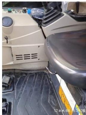
รูปที่ 33 รถชุดเจาะบุ่นั่งด้วยวัสดุป้องกันความสั่นสะเทือน
